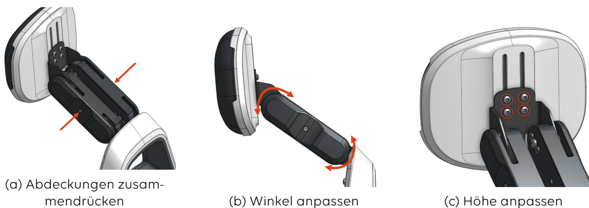
Abbildung 21. Einstellung der Snap Lock Kopfstütze
