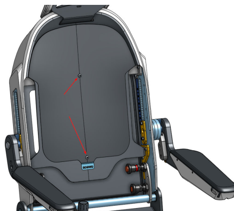
(b) Zu lösende Schrauben zur Entfernung des Rückenlehnen- Inlays
